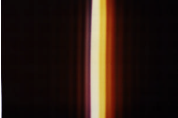
Abb. 3. Beleuchtet mit kontinuierlichem Spektrum nach Abb. 1. Auch hier war die Entfernung nur so groß gewählt, daß gerade äußere Beugungsstreifen entstanden.
